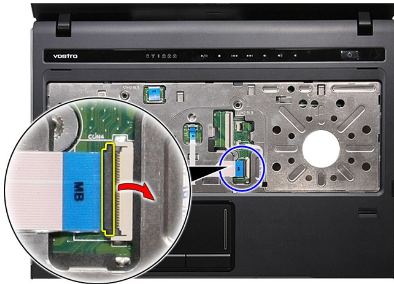
15. נתק את כבל לוח השמע מהמחבר שלו בלוח המערכת.
