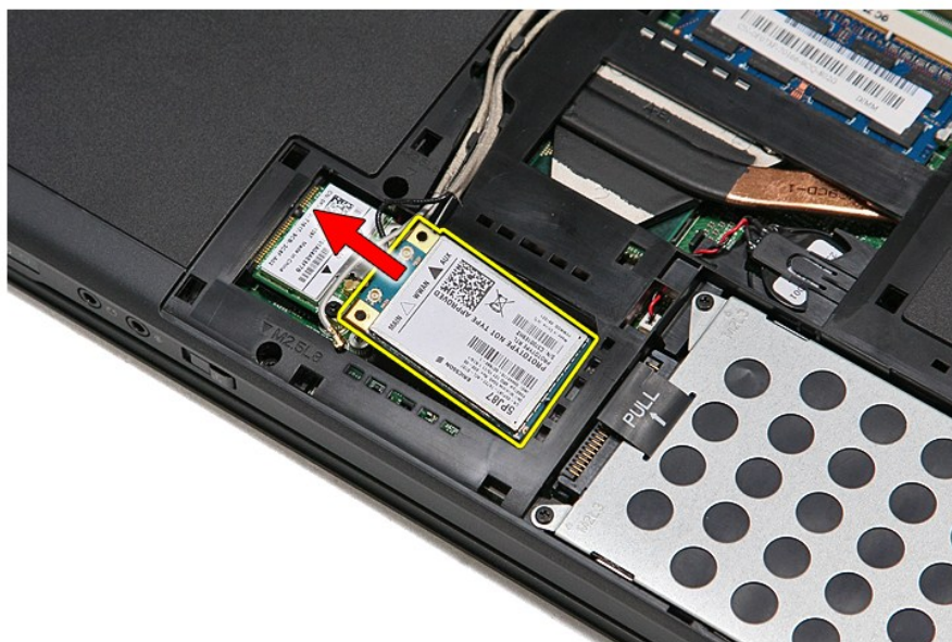
6. משוך והוצא את כרטיס ה-WWAN מהמחבר שלו בלוח המערכת והוצא אותו מהמחשב.
