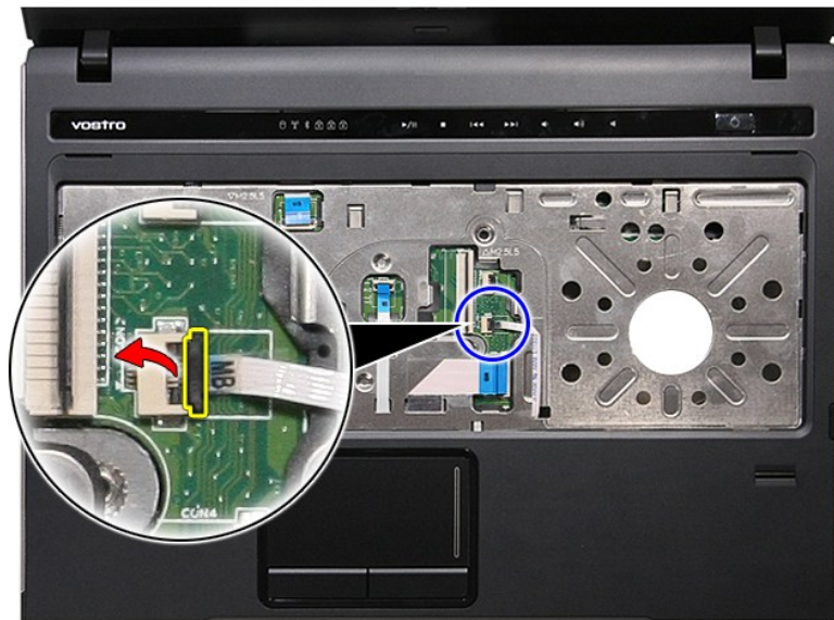
16. פתח את התפס המחבר את כבל קורא טביעות האצבעות ללוח המערכת.
