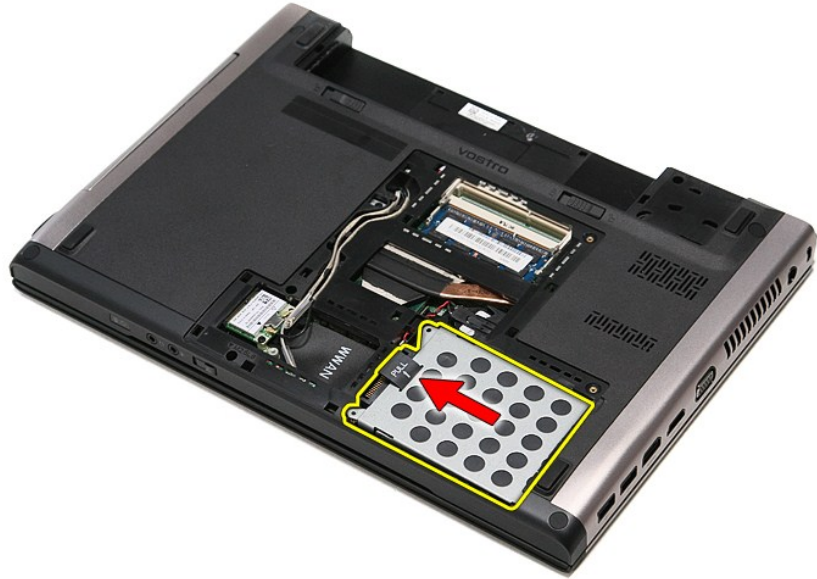
6. הרם את מכלול הכונן הקשיח והסר אותו מהמחשב.
