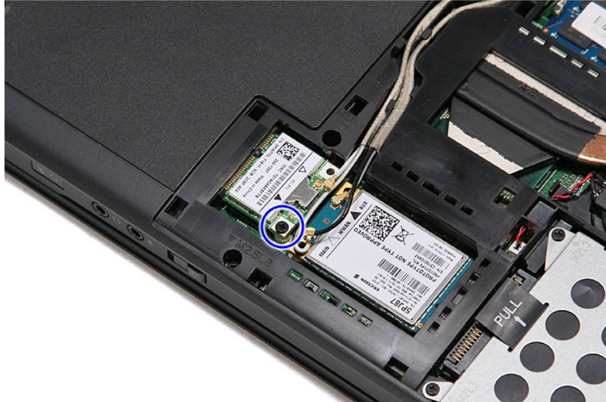
6. משוך בעדינות את כרטיס ה-WLAN מהמחבר שלו בלוח המערכת והוצא אותו מהמחשב.
