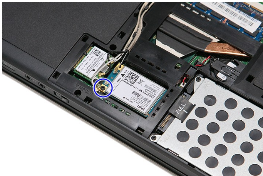
6. משוך והוצא את כרטיס ה-WWAN מהמחבר שלו בלוח המערכת והוצא אותו מהמחשב.
