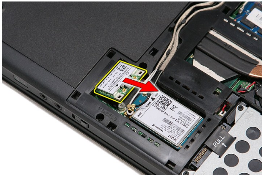
6. משוך בעדינות את כרטיס ה-WLAN מהמחבר שלו בלוח המערכת והוצא אותו מהמחשב.
