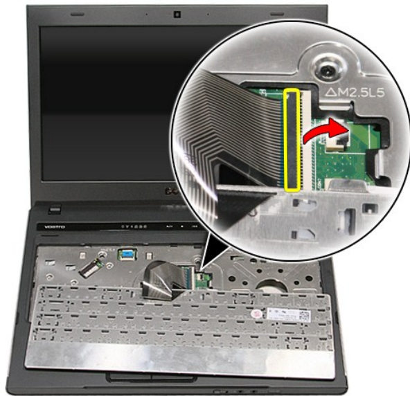
7. משוך והוצא את כבל המקלדת מהמחבר שלו בלוח המערכת והסר את המקלדת מהמחשב.
