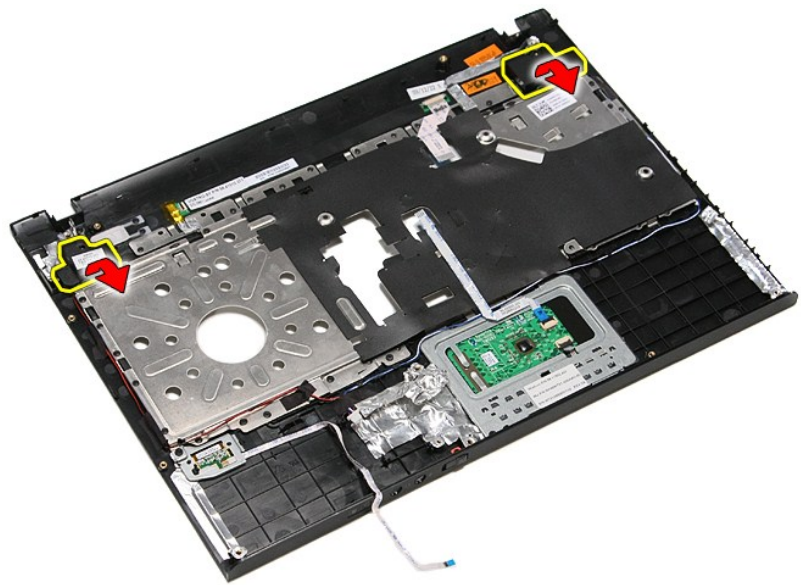
13. שחרר בעדינות את כבלי הרמקולים ממכווני הניתוב שלהם במשענת כף היד, הרם את הרמקולים והרחק אותם ממשענת כף היד.
