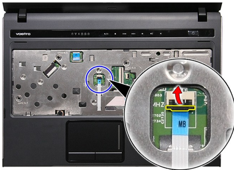
13. נתק את כבל הנתונים של לוח המגע מהמחבר שלו בלוח המערכת.
